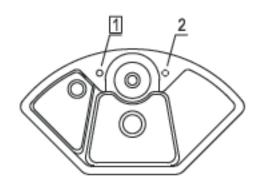
Lochbohrungen: Bei der Bestellung bitte Nummer(n) angeben. Durchmesser: ca. 35 mm
